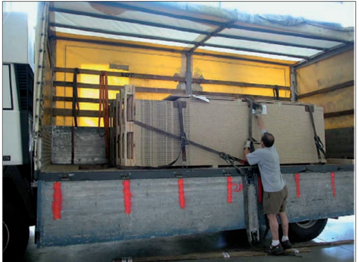
Kombinierte Ladungssicherung: formschlüssige Sicherung nach vorne, kombiniert mit kraftschlüssiger Sicherung durch Niederzurren zur Seite
