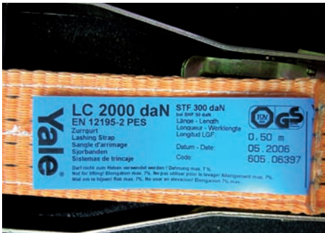
Etikett eines Zurrgurtes mit Standardratsche und S_{TF} -Wert von 300 daN
