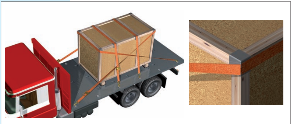
Direktzurren (Kantenwinkel bei fehlenden Zurrpunkten) kombiniert mit Niederzurren
